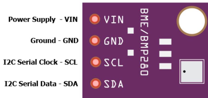
Der Sensor hat einen on-board LM6206 3,3V Spannungsregler und einen Spannungspegelübersetzer. Die Pins des BME280-Sensors können mit Spannungen im Bereich von 3,3V bis 5V betrieben werden, ohne dass eine Gefahr für den Sensor selbst besteht.
